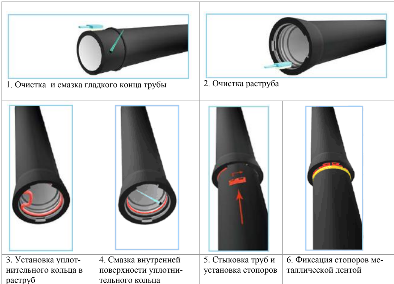
Рисунок 6.6 Монтаж труб под соединение «RJS».
