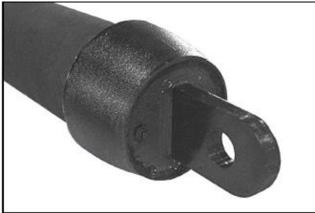
Рисунок 6.21 Приспособление для протягивания труб.
