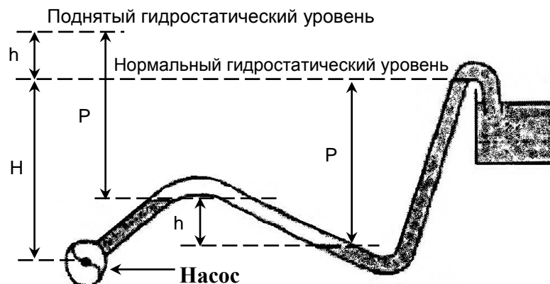
Рисунок 5.4 Условия в напорном трубопроводе.
