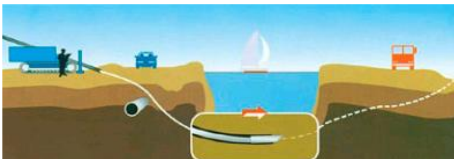
Рисунок 6.18 Бурение пилотной скважины.
